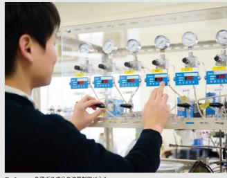
Fig.3 — 各種ガス成分の流量制御パネル
