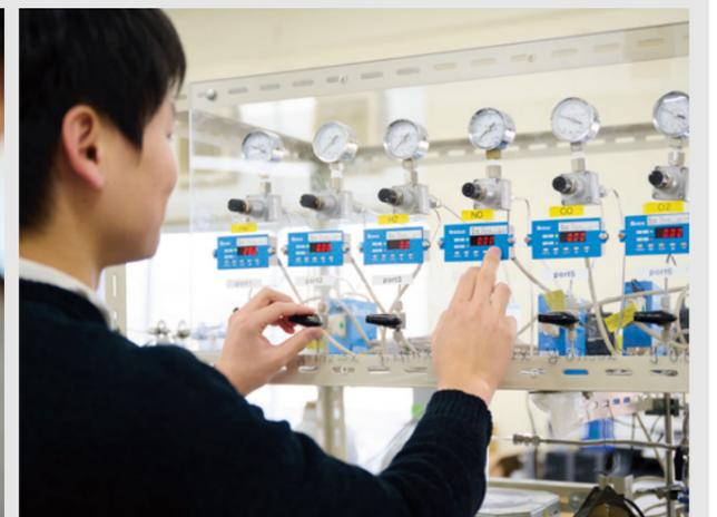
Fig.3——各種ガス成分の流量制御パネル
